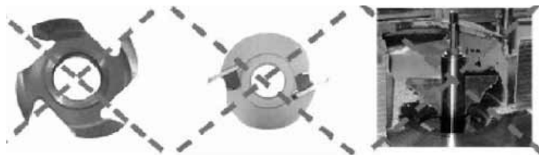
Ejemplos de herramientas que no deben utilizarse en alimentación manual
